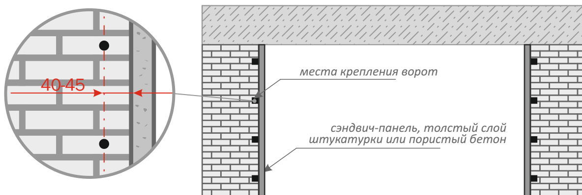
Рис. 11 Места крепления ворот к стенам (вид на левый пристенок изнутри проема).
